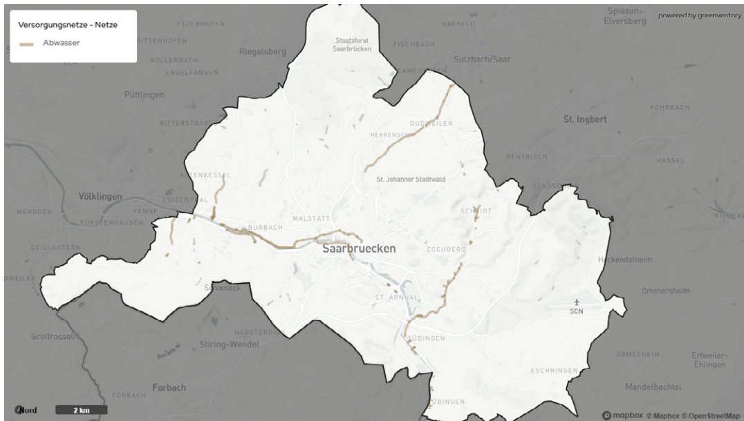
Abbildung 23: Bestehende Abwassernetze (Mindestnennweite DN 800) in Saarbrücken
